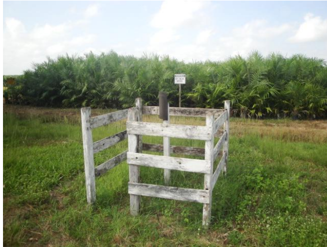
Figura 3- Imagem de pluviômetro utilizado para monitoramento diário de precipitação, instalado nas proximidades das áreas de estudo no município de Castanhal – PA.
