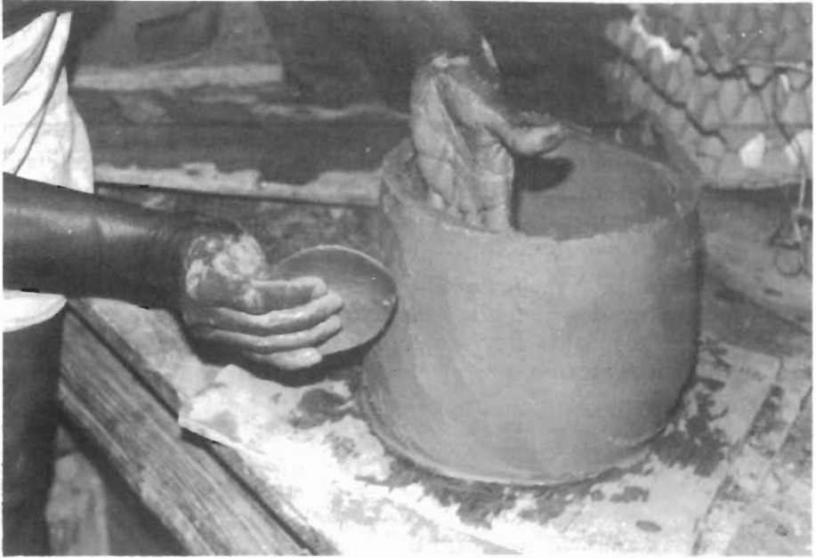
Figura 12 - Alisamento da superfície com ajuda do "cuiupeba".
