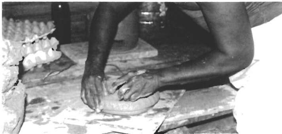
Figura 9 - Modelagem da base do recipiente e elaboração do primeiro rolete.
