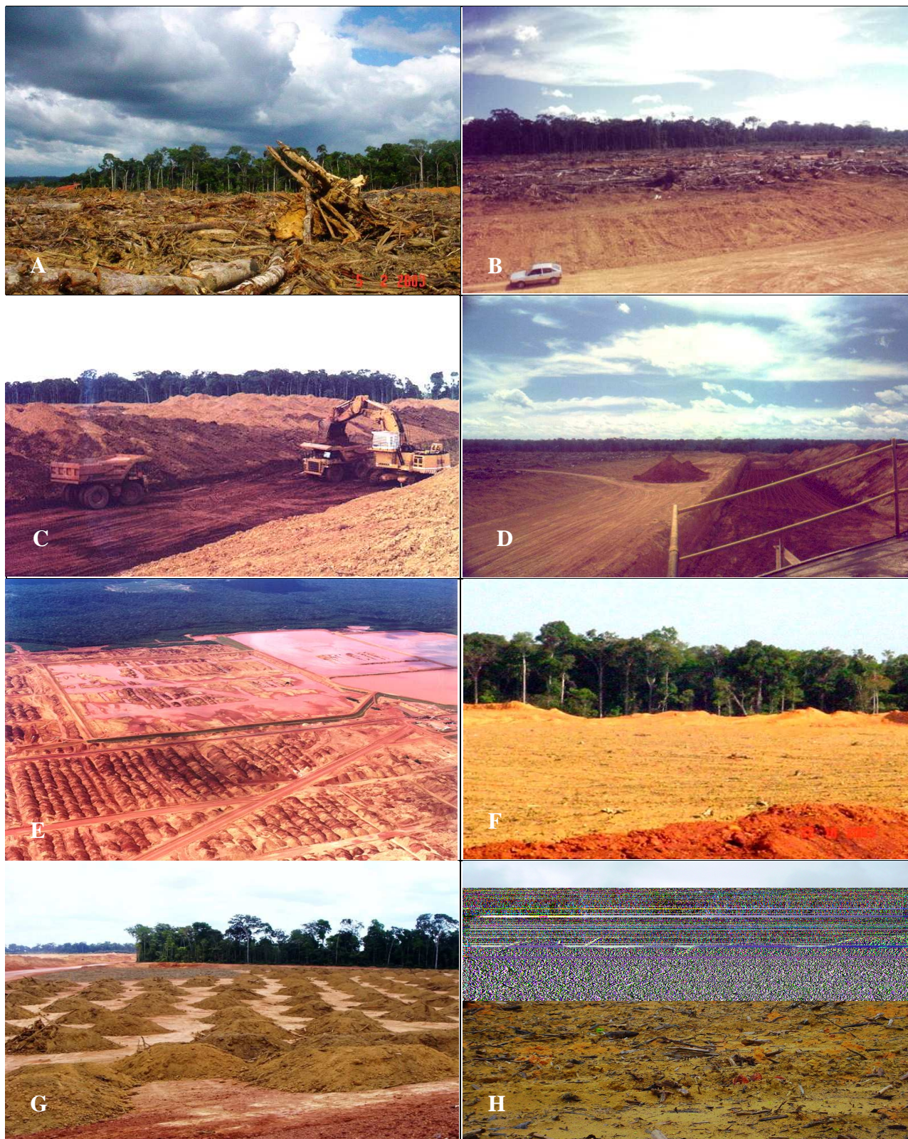
Figura 3. (A) Desmatamento: corte raso da floresta; (B) decapeamento (1º plano), desmatamento e floresta; (C) extração e transporte da bauxita; (D) extração da bauxita em faixas; (E) pós-lavra em faixas da bauxita, essas áreas é que deverão ser restauradas anualmente; (F) área sistematizada pelo trator de esteira; (G) adição de terra preta na área sistematizada para espalhamento superficial; (H) área pronta para o plantio florestal c.a. 80 espécies; FLONA de Saracá Taquera, Porto Trombetas, Oriximiná, Pará.
