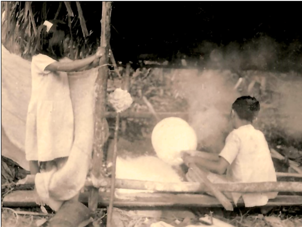
Figura 4. Registro do processo de defumação do látex para a produção das 'bolas' de borracha, provavelmente no seringal Providência, no médio rio Negro. Note-se o envolvimento de crianças e adolescentes no trabalho. Foto de provável autoria de Eduardo Galvão. Fonte: Arquivo Guilherme de La Penha/MPEG, Fundo Eduardo Galvão e Clara Galvão, Fotografias.
