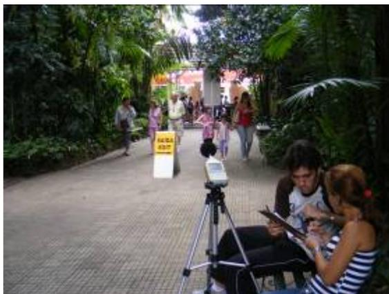
Fig. 12 – Voluntários realizando medições de temperatura, umidade, velocidade do vento e som, na entrada do PZB no domingo.
