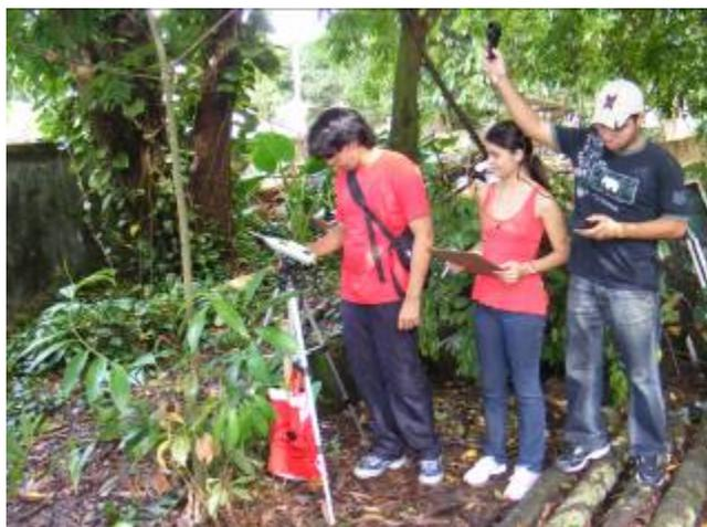
Fig. 11 – Voluntários realizando medições de temperatura, umidade, velocidade do vento e som no PZB.
